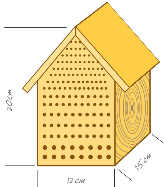
1. In einen großen Hartholzblock (z. B. Eiche oder Buche aber kein Nadelholz verwenden) unterschiedlich breite Gänge mit 3 - 10 mm Durchmesser bohren. Am besten immer quer zu den Jahresringen bohren.
